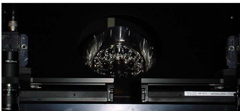
光源は信頼性と経済性を備えた最新型水冷式Ω形光源を採用
